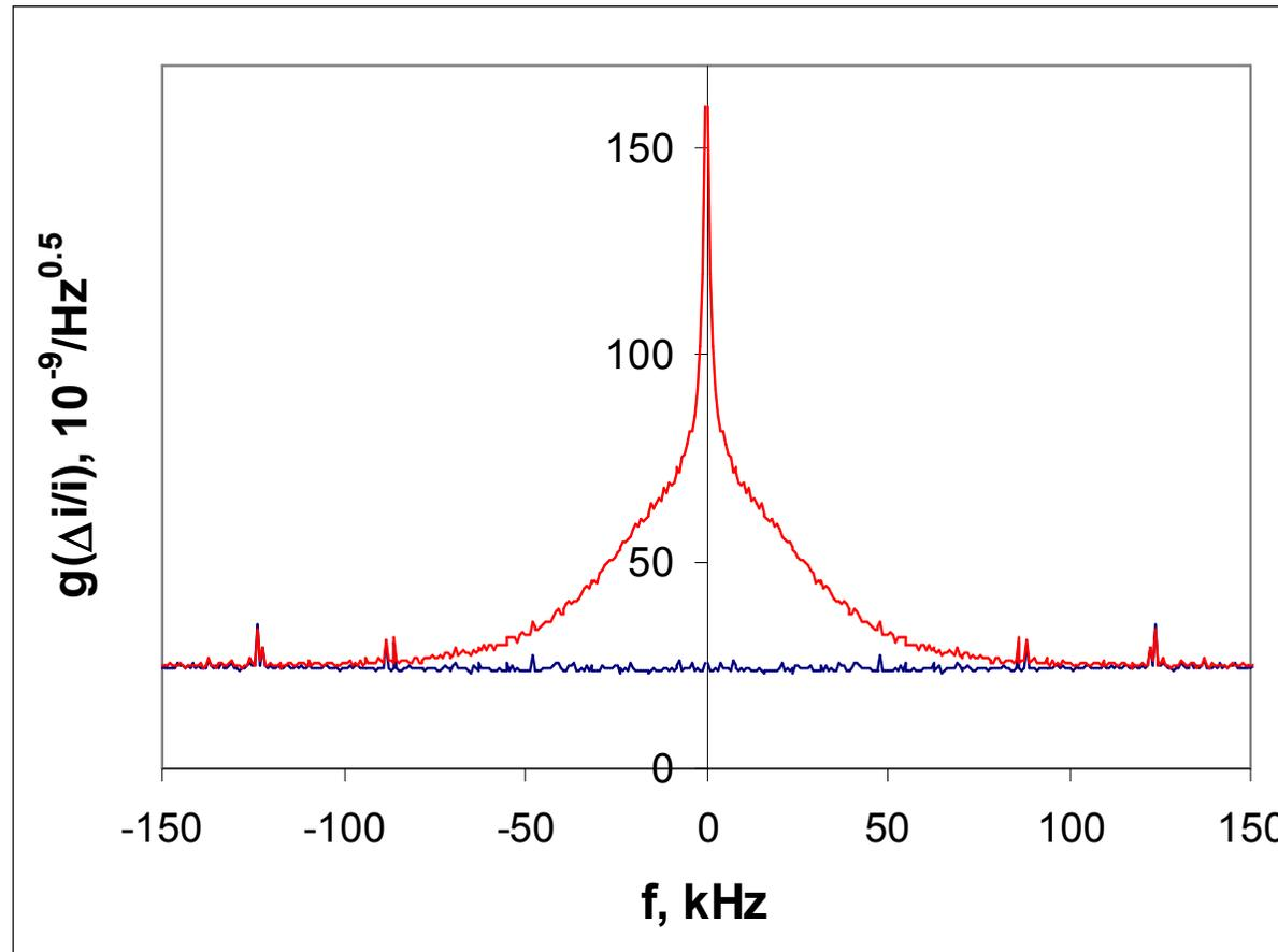
**Надлежащий выбор способа заземления дал в результате отсутствие или существенное уменьшение помех и наводок от внутренних и внешних источников. Это обеспечило отношение сигнал/шум, соответствующее разрешению 16- битовой плате NI DAQ - 65536**
