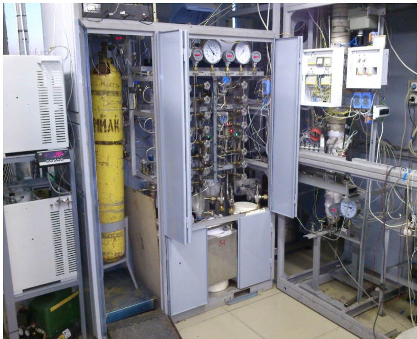
Узел выгрузки высокоочищенного аммиака; Баллон V=118 л производства НПП «Салют»
