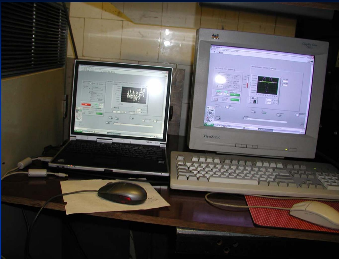
Одновременное измерение концентрации  $UF_6$  (слева) и HF (справа)
