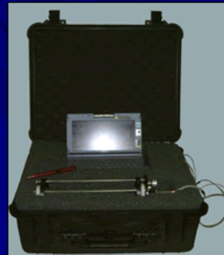
**Система измерения среднего содержания молекулярной примеси в атмосфере для вертолета.**
