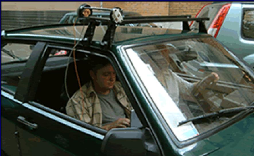
**Система измерения среднего содержания молекулярной примеси внутри движущегося автомобиля.**
